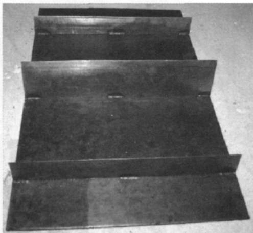
图 2 塑性抗裂试验模具内置钢板(带裂缝引发器)
